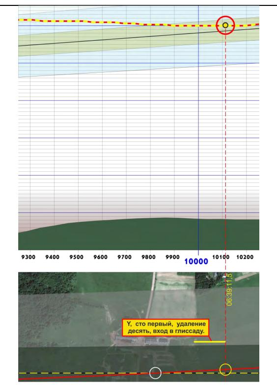
Fig. 24. Location of the aircraft at the moment of command: "Сто первый, удаление десять, вход в глиссаду" (*One zero one, distance ten, entry into glide path*)
